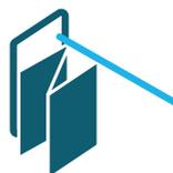
Cloison continue, interconnectée par des charnières cachées, avec son poids suspendu et guidé par un rail au sol. Le rail au sol peut être encastré ou en saillie.
