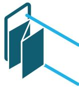
Tabique continuo, interconectado por bisagras ocultas, con su peso suspendido y guiado mediante guías en el suelo. La guía de suelo puede ser empotrada o saliente.
