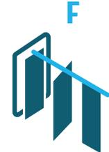
Tabique suspendido con paneles independientes, sin guía en el suelo. Bloqueo manual mediante pestillos al suelo.
