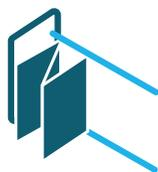
Cloison continue, interconnectée par des charnières cachées, avec son poids suspendu et guidé par un rail au sol.
