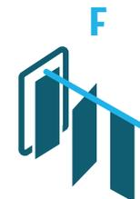
Cloison suspendue à panneaux indépendants, sans rail au sol. Verrouillage manuel au moyen de loquets au sol.
